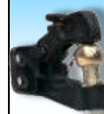
Crochet fixe PERCAGE 4 trous Ø 17 40 x 90 mm Pour rotule Ø 50 ou anneau 42 x 68 - 42 x 76 Traction pour un P.T.C de 3,5 T Poids : 4,9 Kg
